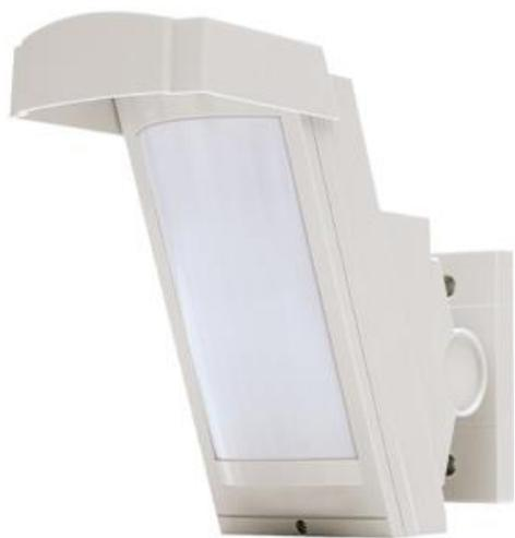
Der SHX12DAM-L ist ein Dual Außensensor mit einem Erkennungsradius von 90°, welcher an einer Außenwand oder an einem Mast montiert werden kann. Bei diesem Sensor wird als Erkennungsmethode sowohl Infrarot passiv als auch Kurzwelle angewendet, der Sensor ist zusätzlich mit „Anti-Masking-Technologie“ ausgestattet.
